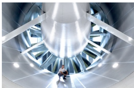
W nowym centrum badań nad aerodynamiką: aerodynamiczny / aeroakustyczny wentylator ma średnicę ośmiu metrów.
